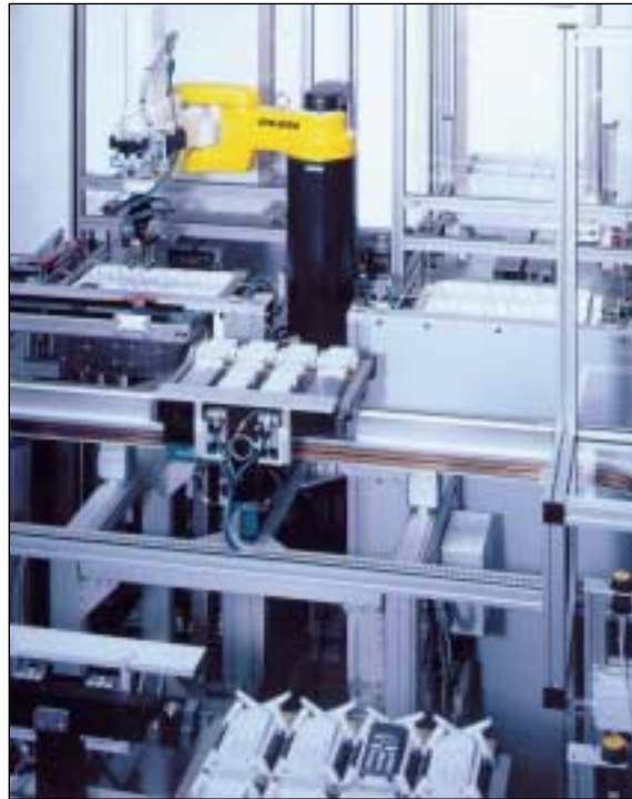
Abb. 2: Allein das Palettenwechselsystem Autostocker von Hirata war in der Lage, die dünnen, zerbrechlichen Paletten zu verarbeiten
