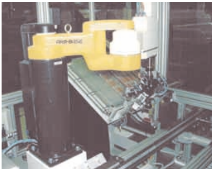
Bild 1: Der Scara AR-S350 arbeitet mit einer Wiederholgenauigkeit von \pm 0,03 mm
