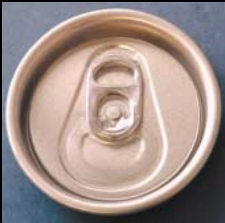
Prüfmerkmale an den Getränkedosendeckeln sind beispielsweise die Restwanddicke in der Ritzlinie – Sollbruchstelle beim Öffnen des Dosendeckels –, der Nietdurchmesser und die Schlagzahlen.
