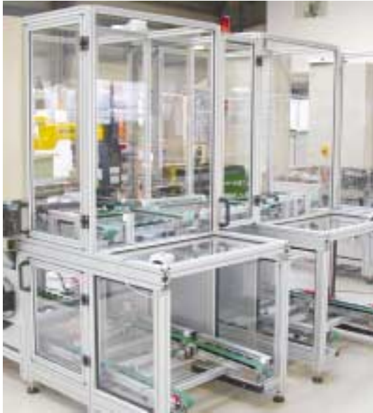
Bild 3: Zwei verknüpfte Palettenwechsler mit Puffermodulen. Hier handelt es sich um eine ziemlich anspruchsvolle Aufgabenstellung
