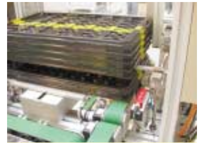
Bild 2: Die unterste Palette wird vereinzelt und auf der Schieberplatte abgelegt. Jede Flussrichtung ist damit möglich
