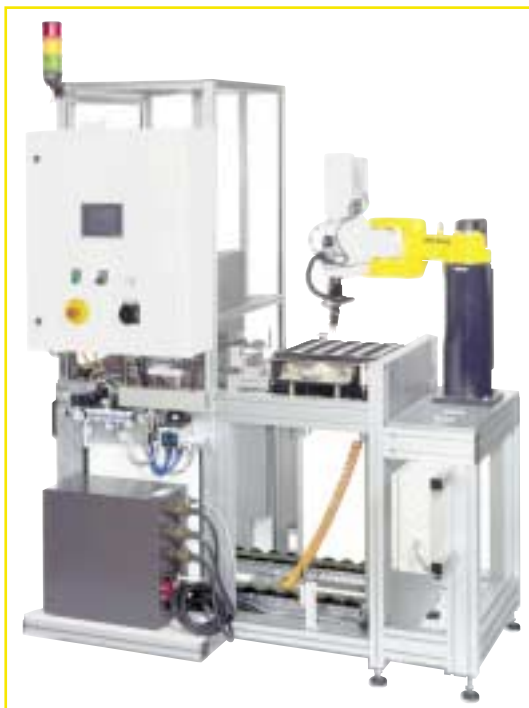
Bild 1: Palettenwechsler sowohl zum Zuführen als auch zum Abführen von unterschiedlichsten Werkstücken
