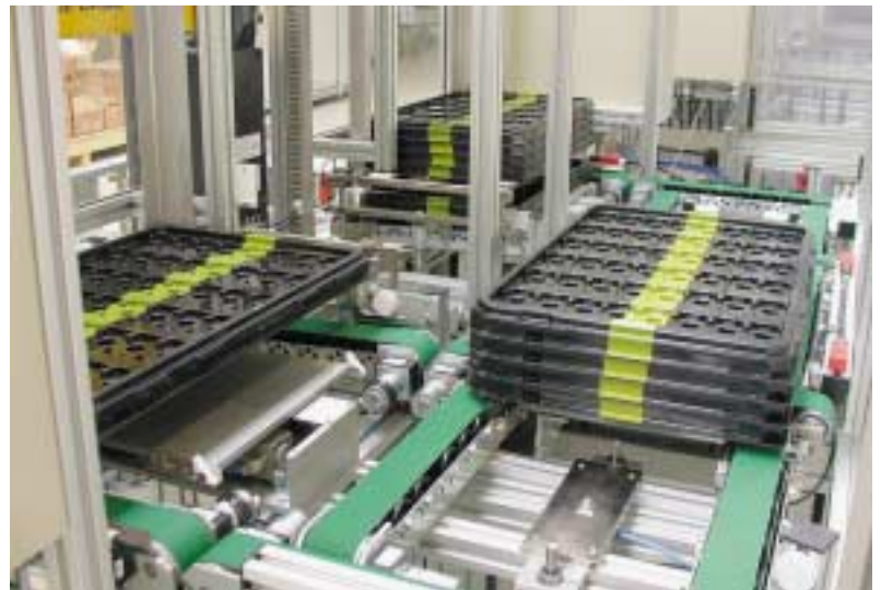
Bild 4: Quertransport von einem Palettenwechsler zum anderen. In diesem Anwendungsfall werden Kfz-Elektronikkomponenten zuverlässig bewegt
