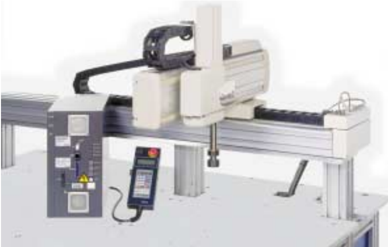
Bild 2: Die an einer Seite des Linearachsensystems angeordnete feststehende X-Achse macht die Zugänglichkeit im Vergleich zu Scara-Robotern schwieriger
