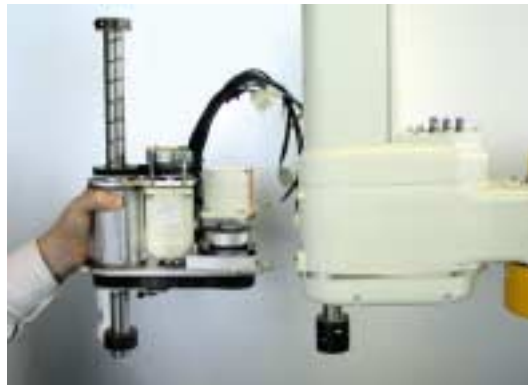
Bild 3. Die gesamte Z/W-Achseneneinheit kann sehr einfach komplett entnommen werden
