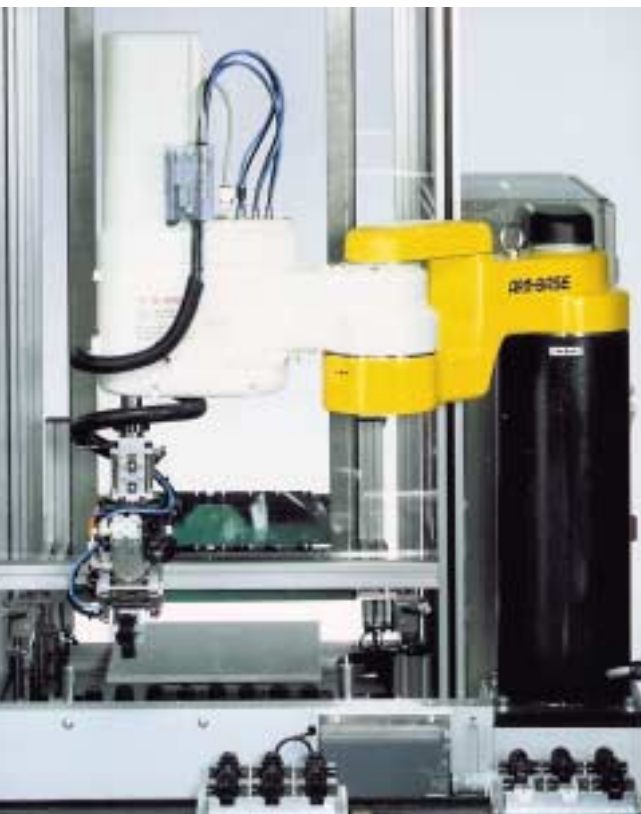
Bild 1. Durch seine vierachsige Kinematik ist der Scara kostengünstiger als vergleichbare Knickarmroboter
