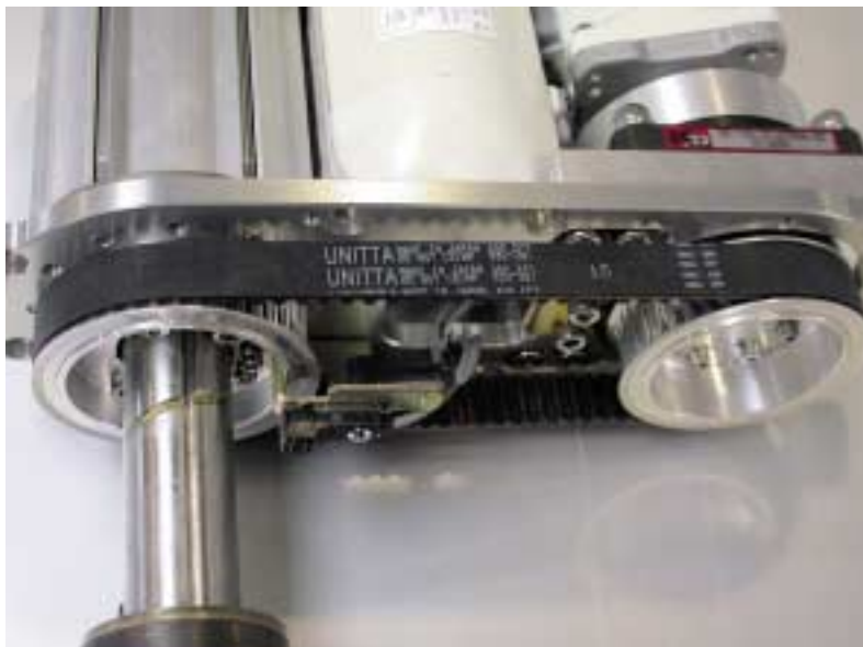
Bild 2. Spindelschmierung und Zahnriemenspannung der Scara-Roboter sollten regelmäßig überprüft werden
