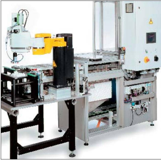
Autostocker mit Scara-Roboter ermöglichen das automatische Zuführen und Wechseln der unterschiedlichsten Trays.
