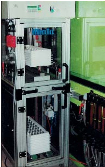
Beengte Platzverhältnisse erfordern schmale Paletten.
