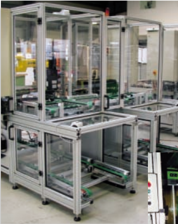
Zwei verknüpfte Autostocker mit Puffermodulen.
