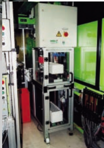
Ein Autostocker übernimmt das Palettieren gespritzter Werkstücke. (Bilder: Hirata)
