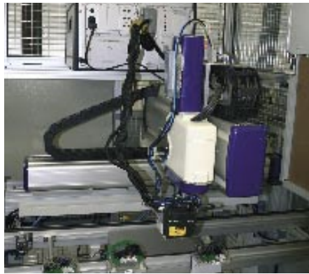
Bild 2: Die Lage bestimmter Komponenten und die thermische Anbindung verschiedener Bauelemente werden geprüft
