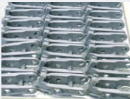
Bild 3: Diese Zwischenhebel für die Ventilsteuerung der BMW-Sechszylinder werden beispielsweise entgratet
