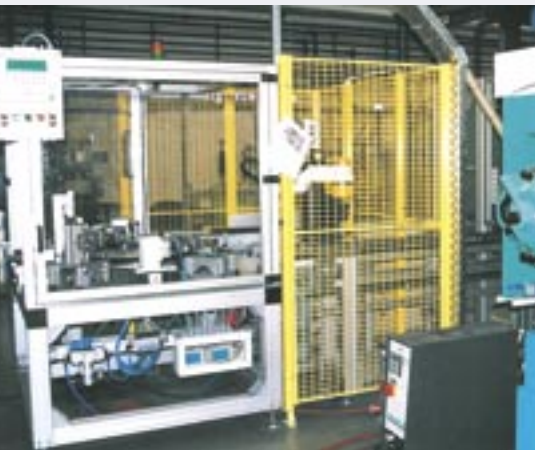
Bild 2: Herzkomponente dieser Entgratungsanlage ist der SCARA-Roboter im Bild links
