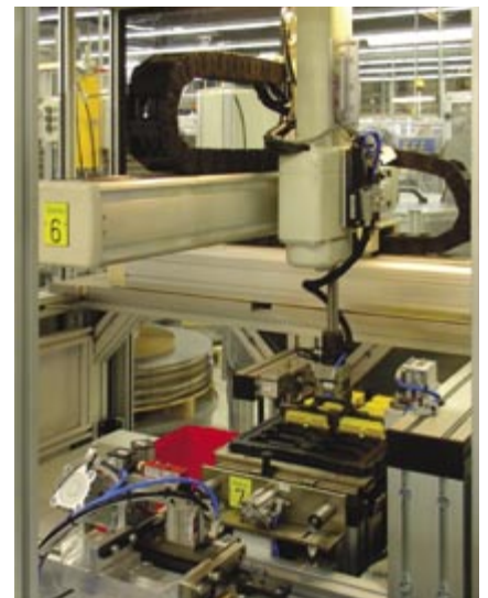
... Anschließend entlädt ein Linearroboter die vereinzelt Palette.
