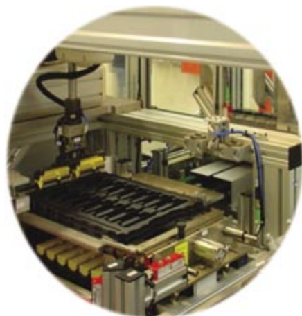
Beim Palettenwechsel setzt die Palette auf der Schieberplatte auf und wird nach hinten gefahren. Dann beginnt sich der Lift zu heben und die nächste Palette wird vereinzelt . . .
